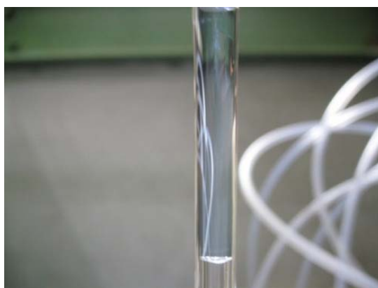
Fig. 2-2 先行研究で作製された、紡糸炉を用いたプリフォーム一体化の例[3]。
