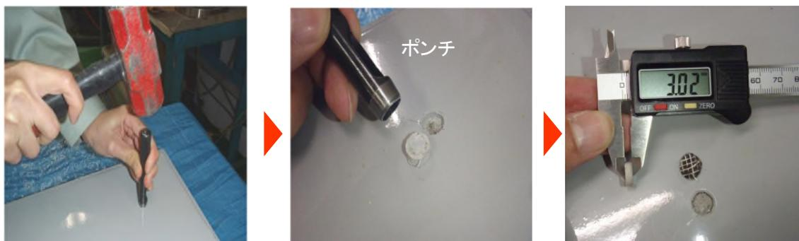
写真 21 ポンチによる抜き取り式膜厚測定の手順
