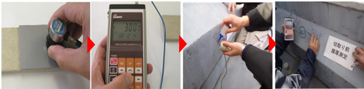
写真 2.4 超音波式の膜厚測定手順
