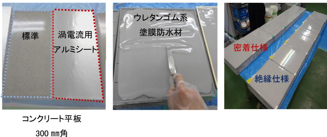
写真 2.10 膜厚測定試験体の作製状況
