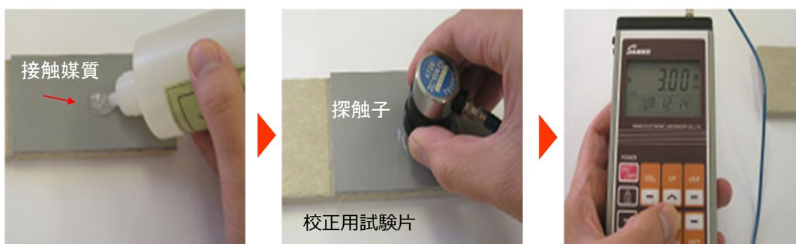
写真7 測定機器の校正手順
