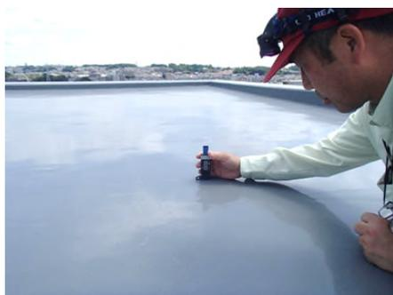
微破壊検査の膜厚測定
