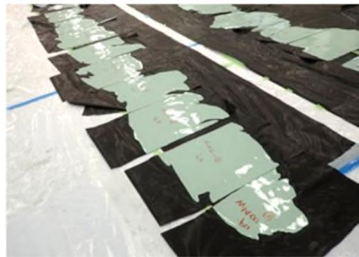
写真 3.7 防水材料硬化後の切断状況
