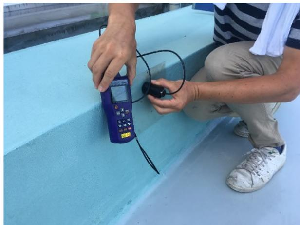
写真 2.2 膜厚測定検査状況
