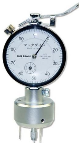
写真 18 針入式膜厚計測定状況
