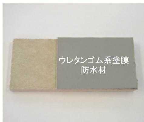
写真6 校正用ウレタンゴム系塗膜防水
