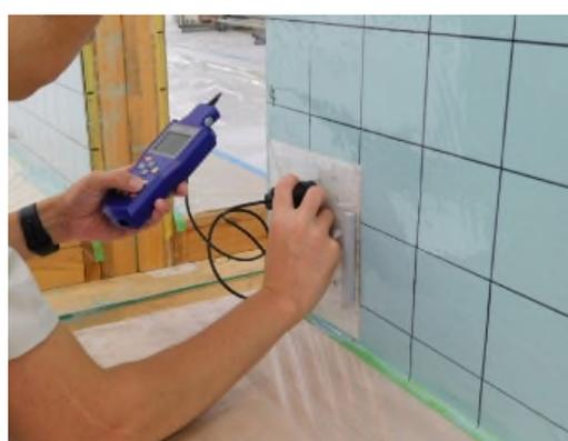
渦電流膜厚計による測定状況
