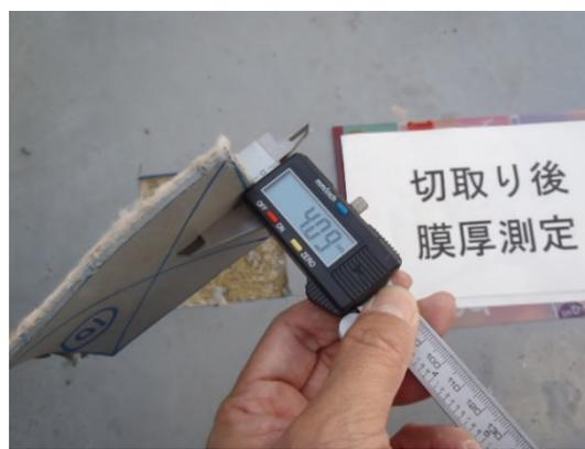
写真 25 カッター等による切り取り式膜厚測定の手順
