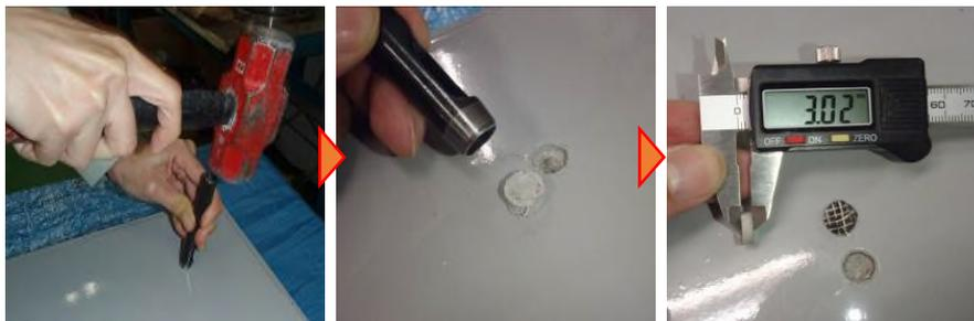
写真 2.8 ポンチ切り取り式測定法の施工手順
