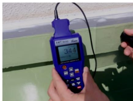
非破壊検査の膜厚測定
