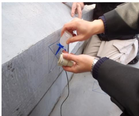
写真 8 接触媒質塗布状況
