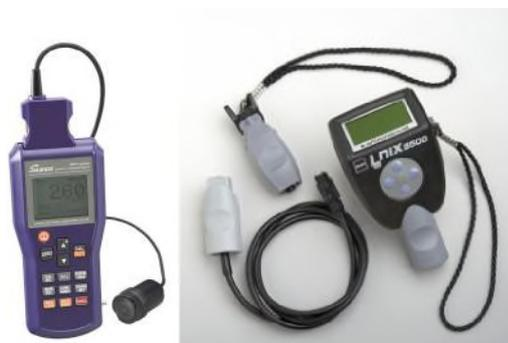
写真12 渦電流式膜厚計
