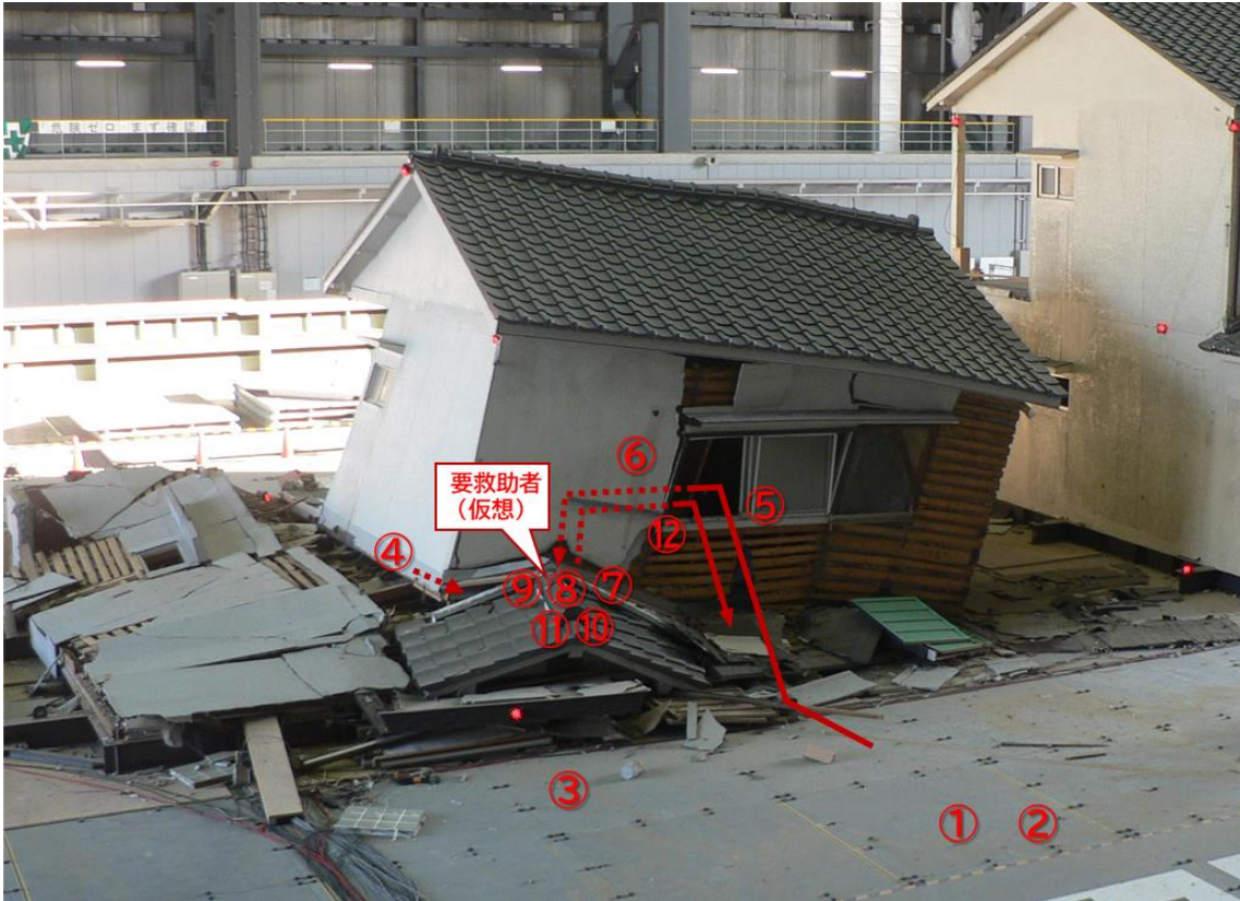
図 1-5-7 「1 階のみ倒壊」の場合の救助活動プロセスの想定（例示） （写真：E-Defense における振動破壊実験時の状況 提供：清水秀丸氏）
