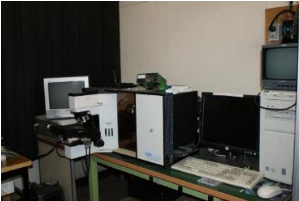
図 2-3 使用した顕微ラマン分光分析装置の外観 (LabRam)
