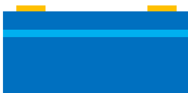
図 3.6 Au エッチ+レジスト除去
