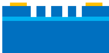
図 3.10 Si エッチ+レジスト除去
