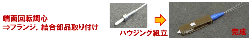
図 3.9.4 MU コネクタ型ファンアウトの作製方法
