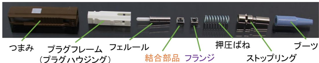
図 2.6.9 MU 形 MCF 用コネクタに使用される部品
