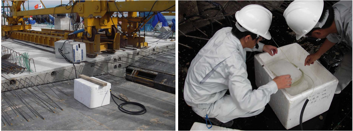
図 2.25 光ファイバ分布計測における位置合わせ（実施状況）
