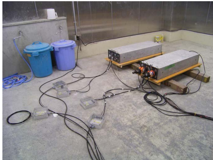
図 2.15 光ファイバセンサ適用 PC 試験の状況
