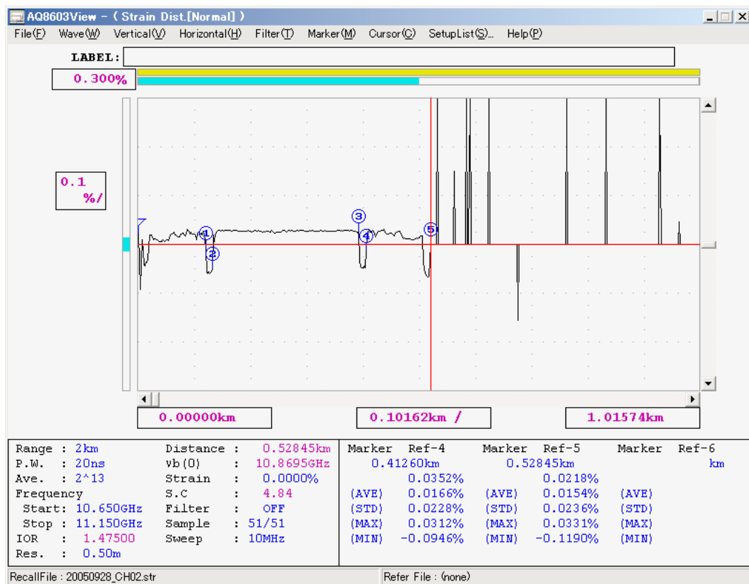
図 2.26 光ファイバ分布計測における位置合わせ（計測結果）
