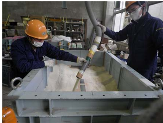
写真-2.3 空中落下法による地盤形成状況
