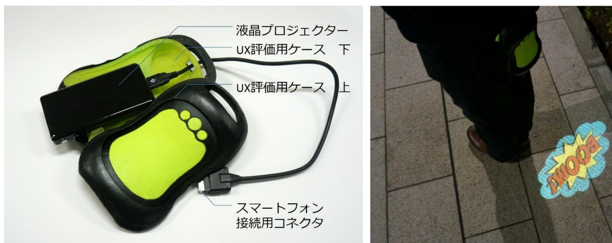
図 4-13 ユーザーエクスペリエンス評価用プロトタイプ(左)と評価の様子(右)
