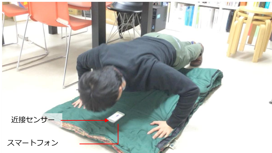
図 5-7 近接センサーのテストの様子
