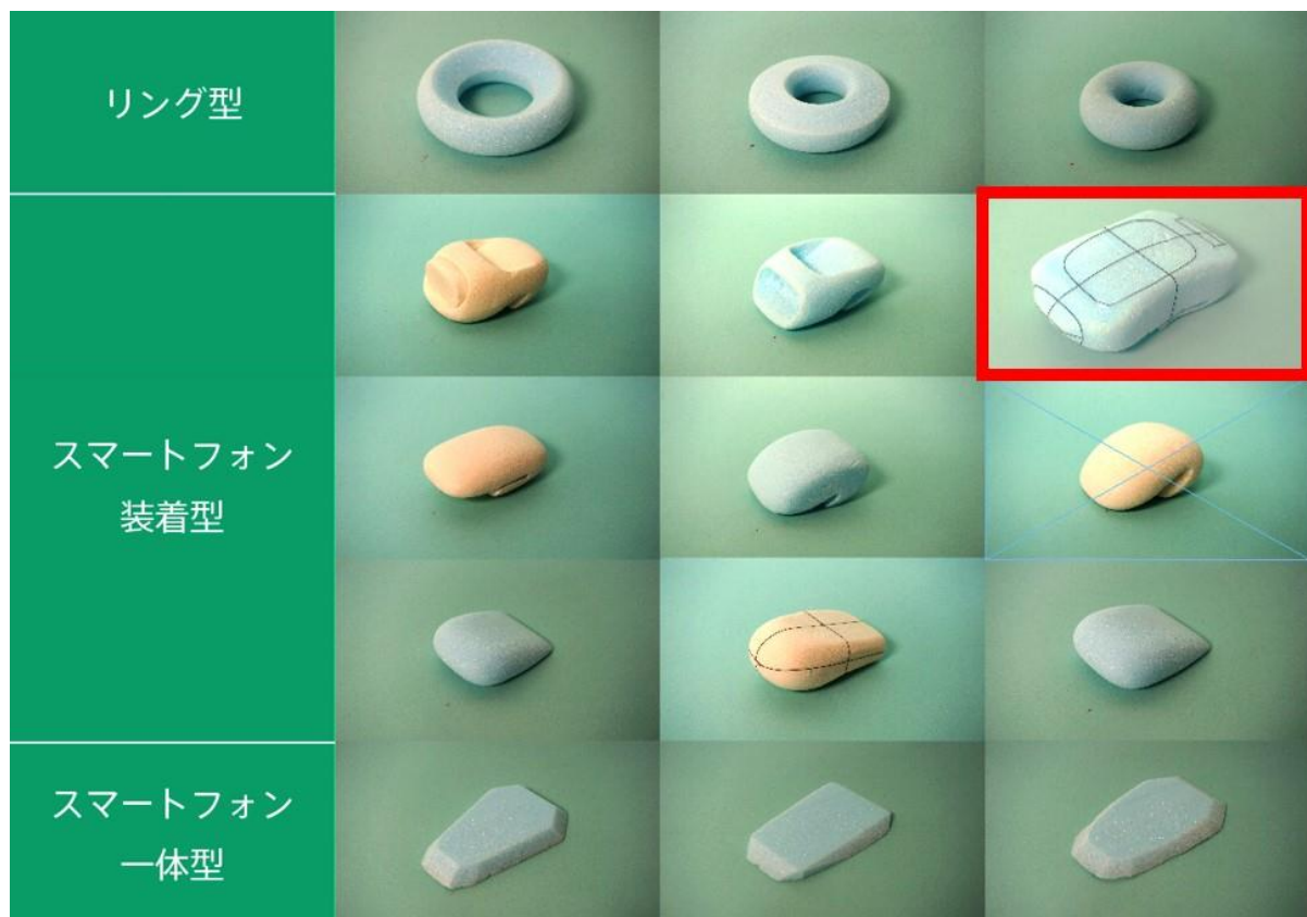
図 4-8 発泡スチロールによるモックアップの制作
