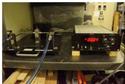
写真 2-10 微差圧計の概観
