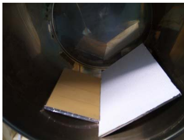
写真 4-1 小型チャンバー 試験体設置状況
