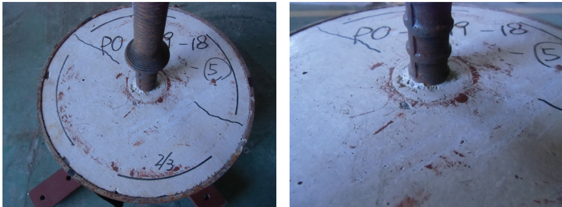
写真4-3-3 クリープ試験後の試験体状況(鉄筋D19, 載荷荷重比0.67)
