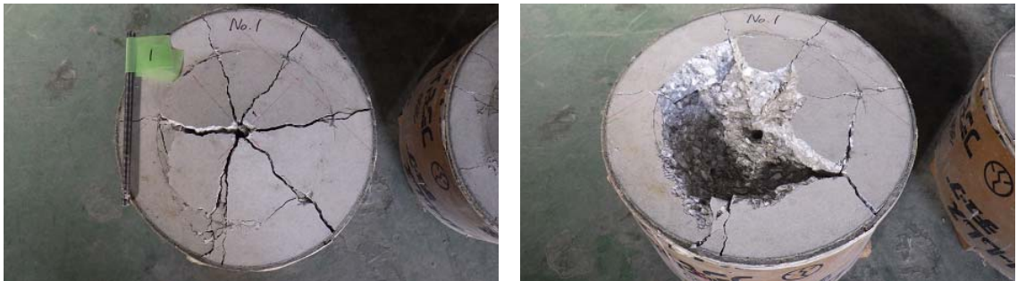
写真 4-2-3 クリープ試験前引張強度試験時の破壊状況
