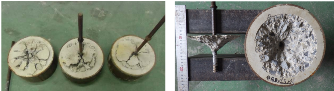
写真 4-3-5 試験体破壊状況
