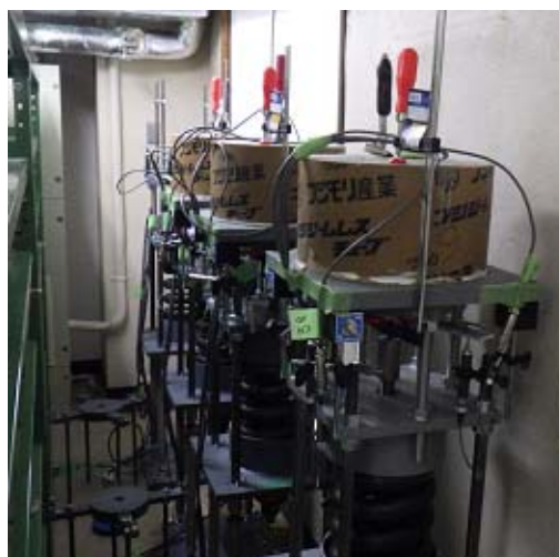
写真 4-2-2 長期載荷試験装置
