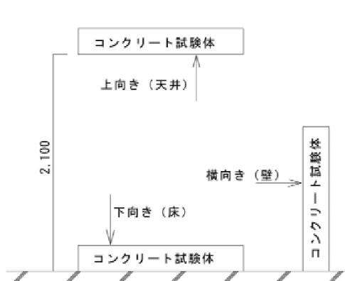
図 3-3-5 アンカー筋施工方向
