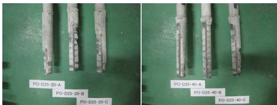
写真 3-3-1 アンカー筋周りのアンカー材の破壊状況
