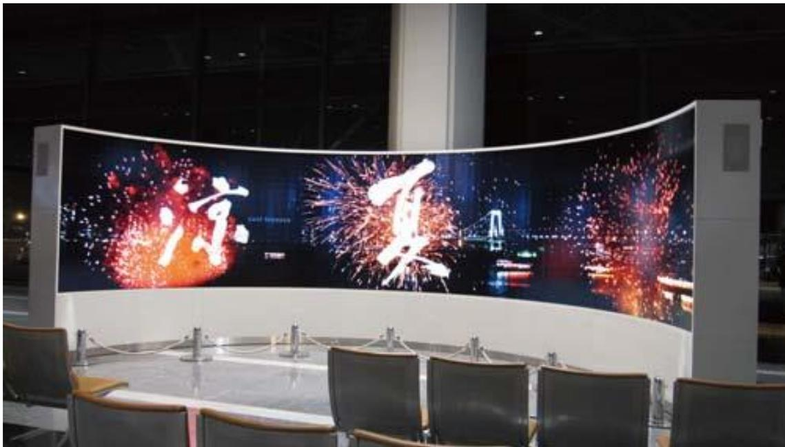
図 4.9. 世界初の「凹型有機 EL 表示装置」(第一ターミナル 4 階に設置)
