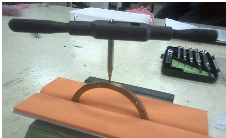
図 2-26 Top の上部リングにネジ穴を製作している様子
