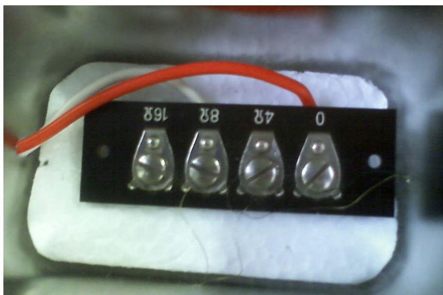
図 2-17 ターミナルボックス内部の基盤 (表側)
