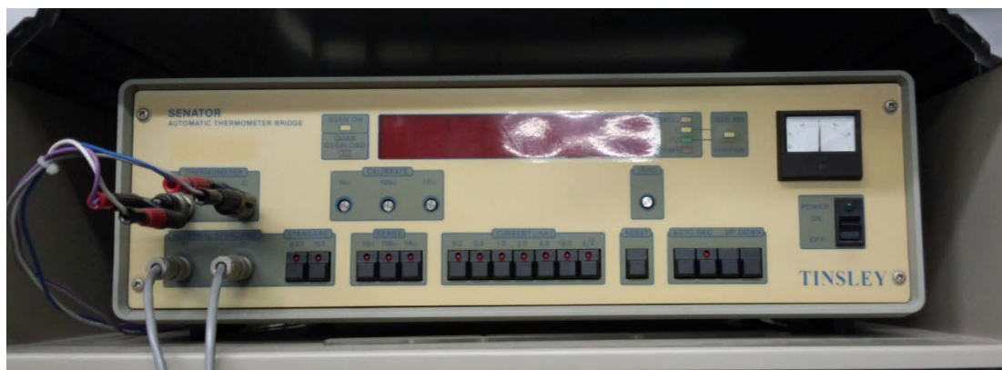
図 2-42 Tinsley 社製の温度交流ブリッジ(5840D 型)
