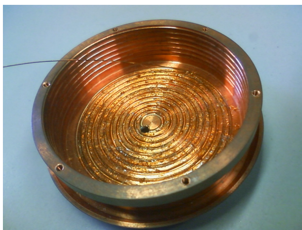
図 2-5 ヒーター線を固定し終えた断熱シールド (Block)
