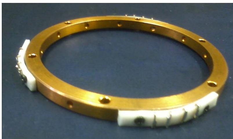
図 2-27 ターミナルを取り付けた Top 上部のリング
