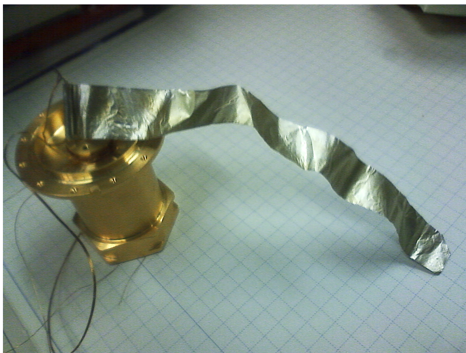
図 2-37 セルカバーに温度計を取り付けている様子
