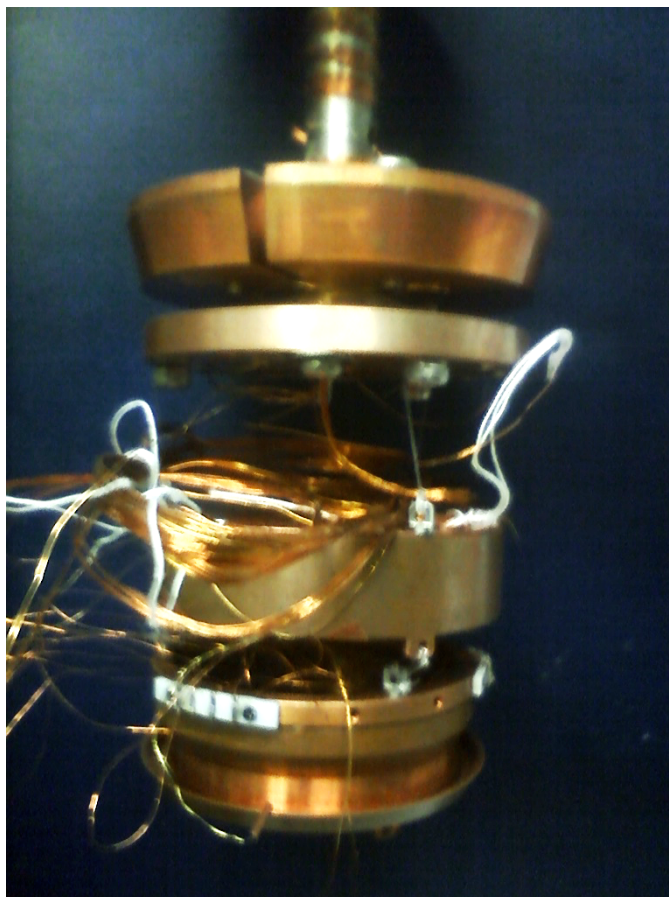
図 2-35 Block と Top を取り付けたセンタースティックの先端部
