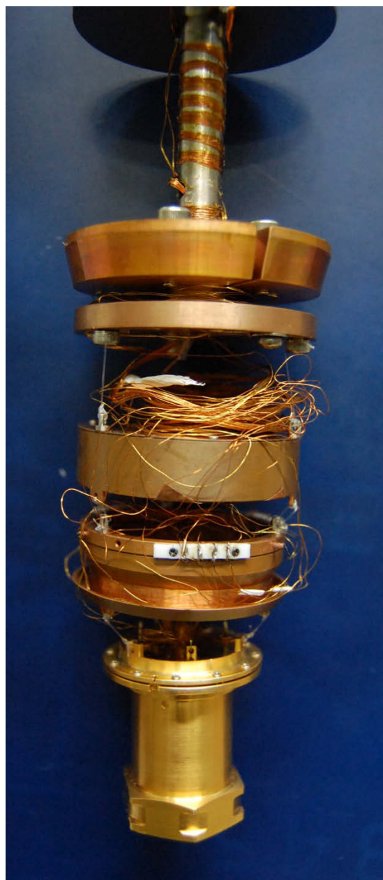
図 2-41 完成したセンタースティックの先端部
