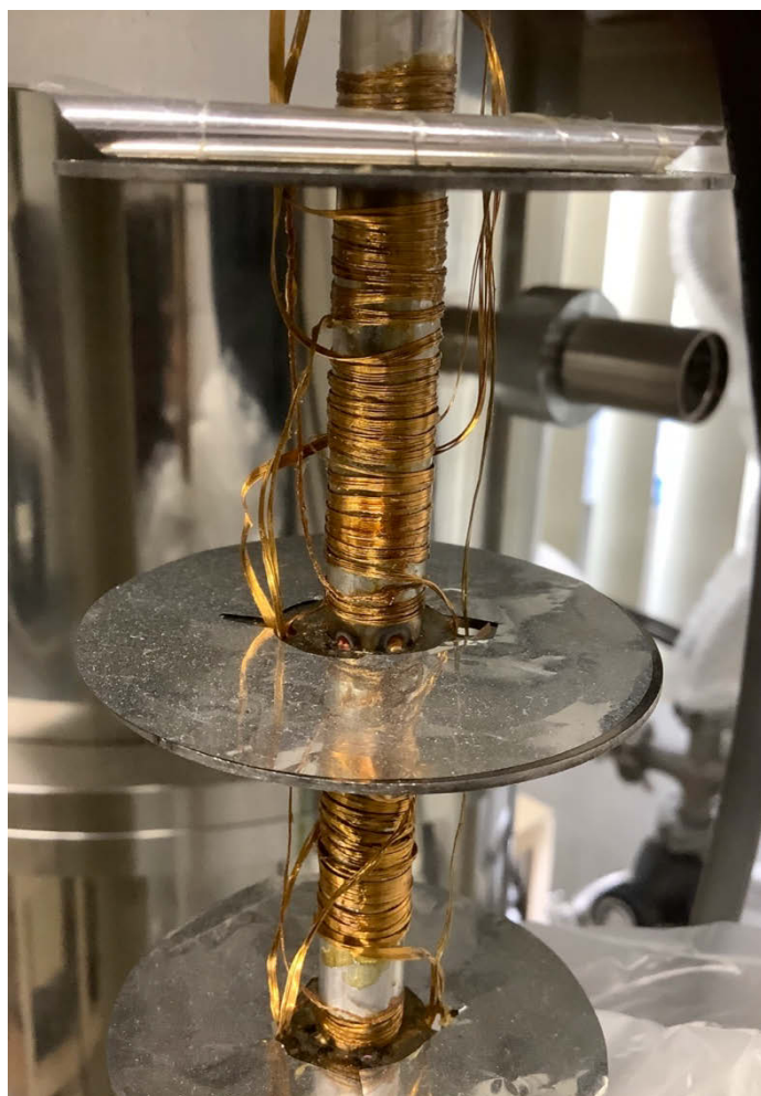
図 2-30 リード線を固定し終えたセンタースティックの一部分
