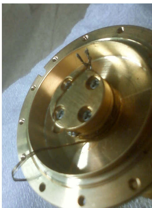
図 2-39 白金抵抗温度計を温度計ホルダーに取り付けたセルカバー
