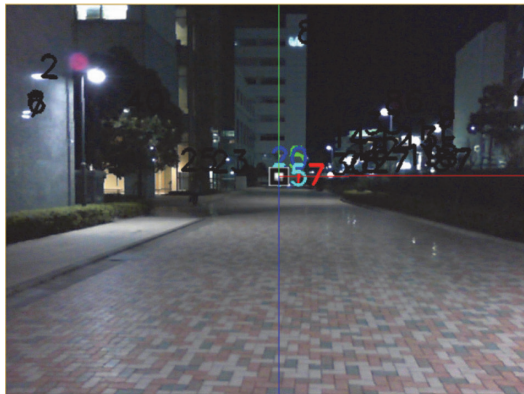
図 7 3.6 m × 3.6 m マーカの約 100 m 地点での マーカ認識成功
