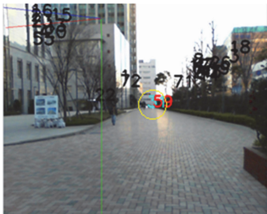
図 8 200 m 地点から LED の点滅を認識した様子
