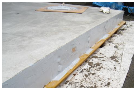
写真2.9 試験体側面エポキシ樹脂コーティング
