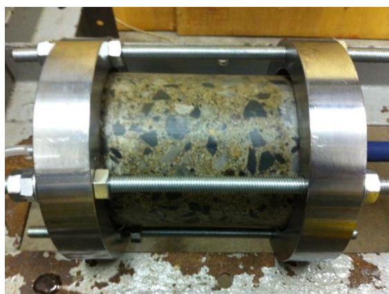
写真2.20 試験体の取付け
