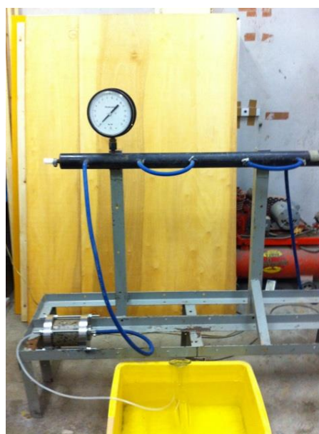
写真2.21 コンクリートの透気係数測定状況
