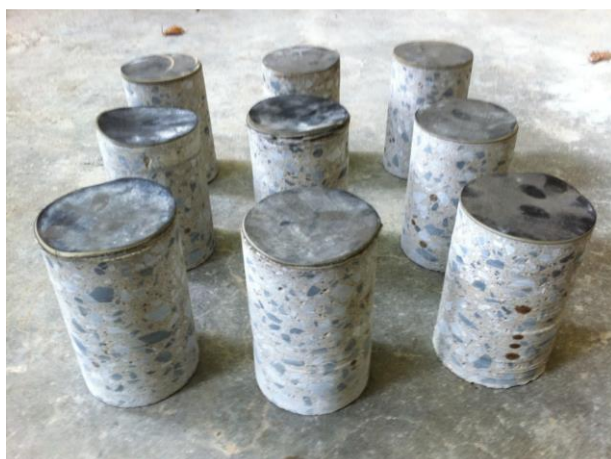
写真2.17 屋外試験時の コンクリート下地コア抜きサンプル
