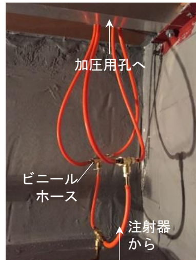
写真3.12 一部加圧の方法
