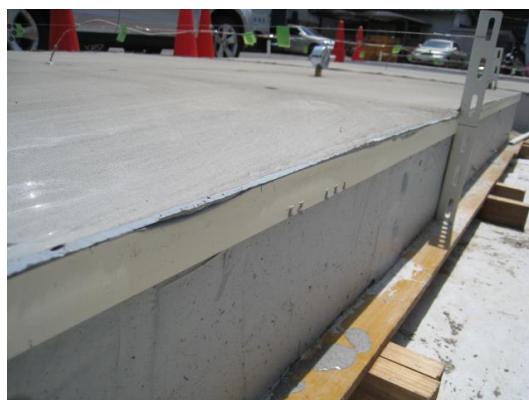
写真2.10 通気緩衝工法試験体 側面納まり
