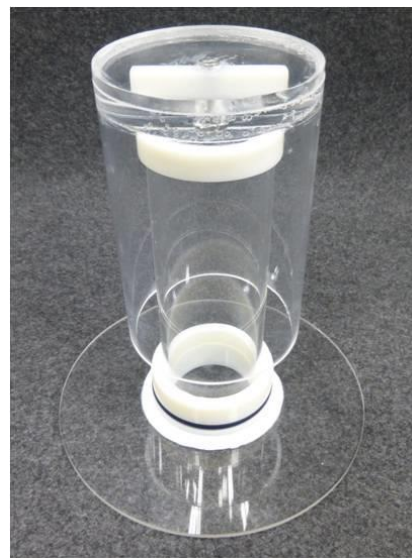
写真3.7 作製した脱気装置
