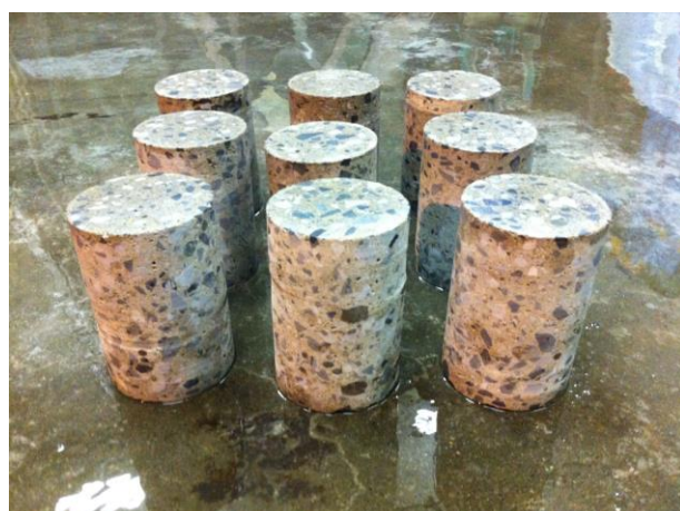
写真2.18 防水層を取り除いたコア抜きサンプル
