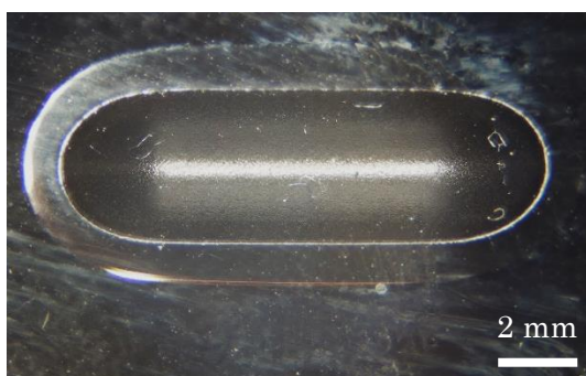
(a) 平凸レンズで焦点はずしをしたもの
