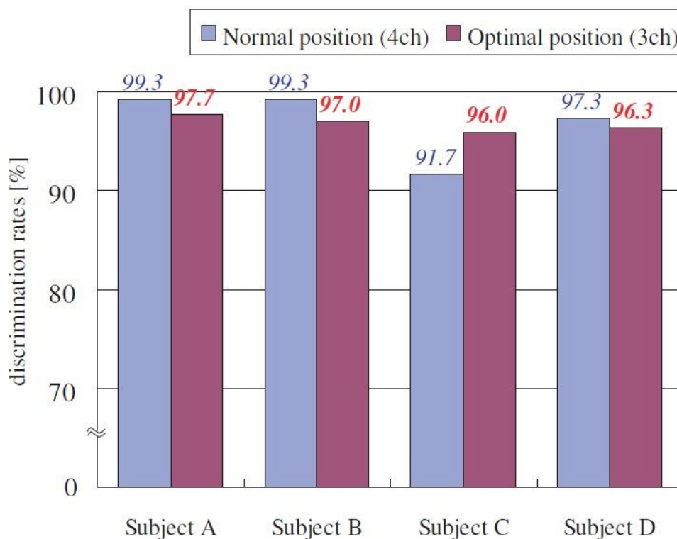
図 6-5 最適位置（3ch）と標準位置（4ch）による動作識別実験結果
